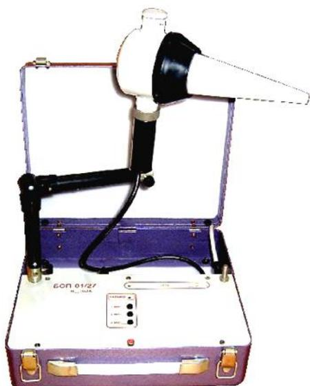
Представляет собой генератор ультравысокой частоты, питающий ртутно-кварцевую лампу ВРМ-1 – источник ультрафиолетового излучения.
